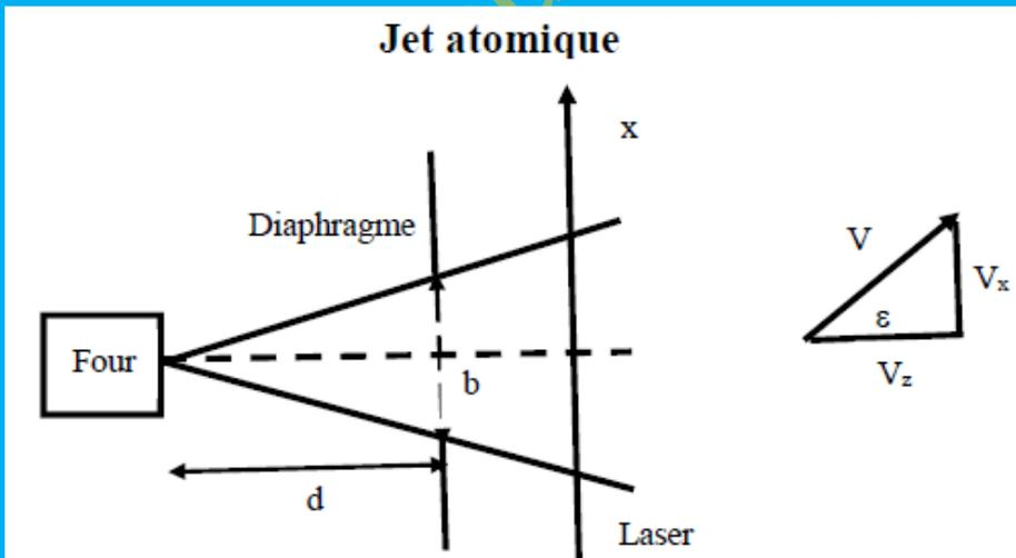
Pour un observateur situé dans une direction perpendiculaire au jet atomique, seuls les atomes dont la vitesse est comprise entre  $v_x$  et  $-v_x$  participent à la désexcitation. La raie observée aura une largeur spectrale égale à :
