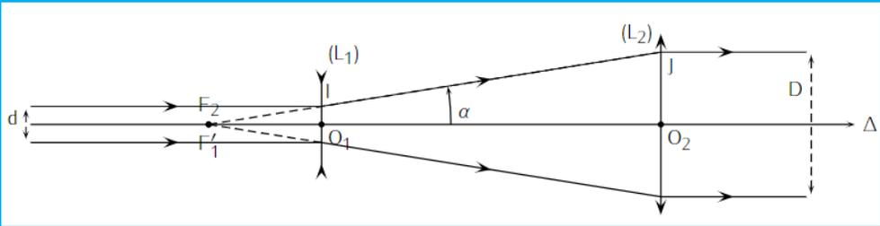
**Elargisseur de faisceau lumineux-Association d'une lentille divergente et d'une lentille convergente.**
