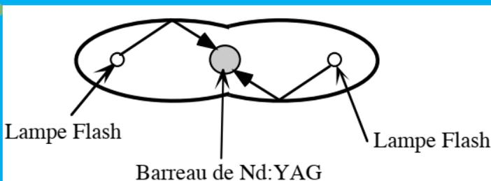
Le pompage s'effectue par deux lampes flash au xénon placées de part et d'autre du barreau. L'ensemble est placé dans une cavité doublement elliptique (chaque lampe se trouve au foyer d'une des ellipses, le barreau de Nd-YAG est au foyer commun aux deux ellipses). L'ensemble est refroidi par une circulation d'eau.
