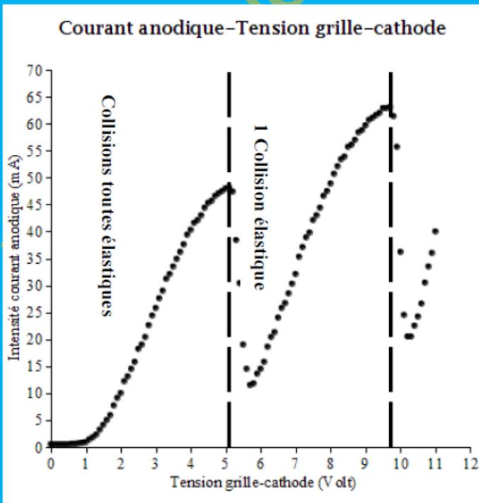
On remarque une première baisse de l'intensité du courant anodique pour une valeur de la tension grille-anode égale à 4,9 volt puis une seconde baisse de l'intensité du courant anodique pour une valeur de la tension grille-anode égale à 9,8 volt et certainement une troisième baisse de l'intensité du courant anodique pour une valeur de la tension grille-anode égale à 14,7 volt et ainsi de suite.
