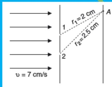
Pour savoir si au point A, on a une interférence constructive ou destructive on doit calculer la différence de marche entre les faisceaux issus des fentes 1 et 2.
