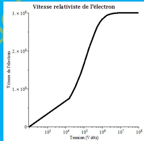
Les figures ci-dessus montrent les vitesses classique et relativiste de l'électron en fonction de la tension d'accélération  $V$ .
