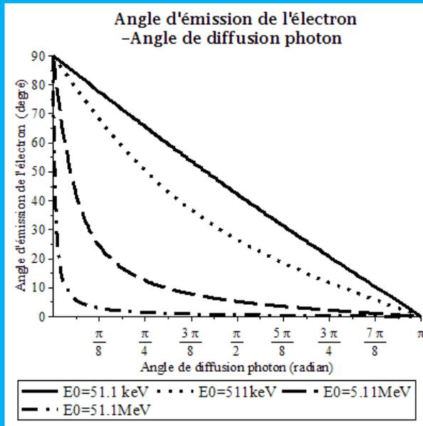
La figure ci-dessus montre la dépendance de l'angle  $\varphi$  en fonction de l'angle  $\theta$ . On constate que lorsque  $\theta = 0^\circ$  on a  $\varphi = 90^\circ$  et lorsque  $\theta = 180^\circ$  on a  $\varphi = 0^\circ$  et cela quelle que soit la valeur de l'énergie  $E_0$  du photon incident.
