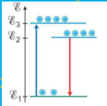
**3°)** Dans un tel laser, l'émission stimulée qui correspond à la transition (2) → (1) détruit l'inversion de population entre les niveaux (2) et (1), ce qui pour conséquence la disparition de l'effet laser. Un tel laser ne peut fonctionner qu'en mode pulsé.
