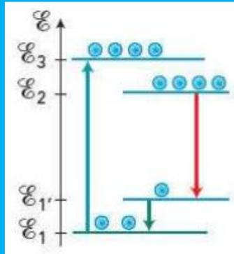
Le pompage optique permet de réaliser la transition  $(1) \rightarrow (3)$  et l'émission stimulée correspond à la transition  $(2) \rightarrow (1')$ .
