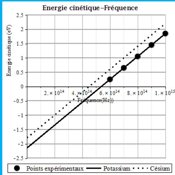
III°) Pour le césium, la droite est parallèle à celle du potassium ; Elle passe par le point de coordonnées  $E_c = 1 \text{ eV}$  et  $\nu = 7.10^{14} \text{ Hz}$ . Son équation est :
