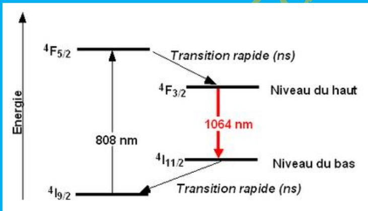
La figure ci-dessus montre le cycle de pompage du laser Nd-YAG.
