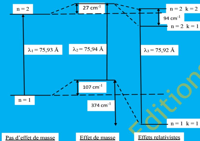
En prenant en compte la règle de sélection  $\Delta k = \pm 1$ , on observera uniquement la transition entre le niveau  $(n = 1, k = 1)$  et le niveau  $(n = 2, k = 2)$  de longueur d'onde  $\lambda_3 = 75,92 \text{ \AA}$ .
