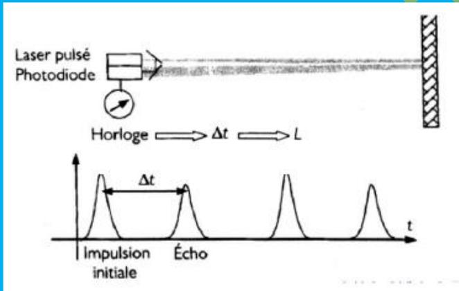
On en déduit la distance  $L$  à partir de la mesure du retard  $\Delta t$  qui représente le temps mis par l'impulsion laser pour effectuer un trajet Terre-Lune-Terre.
